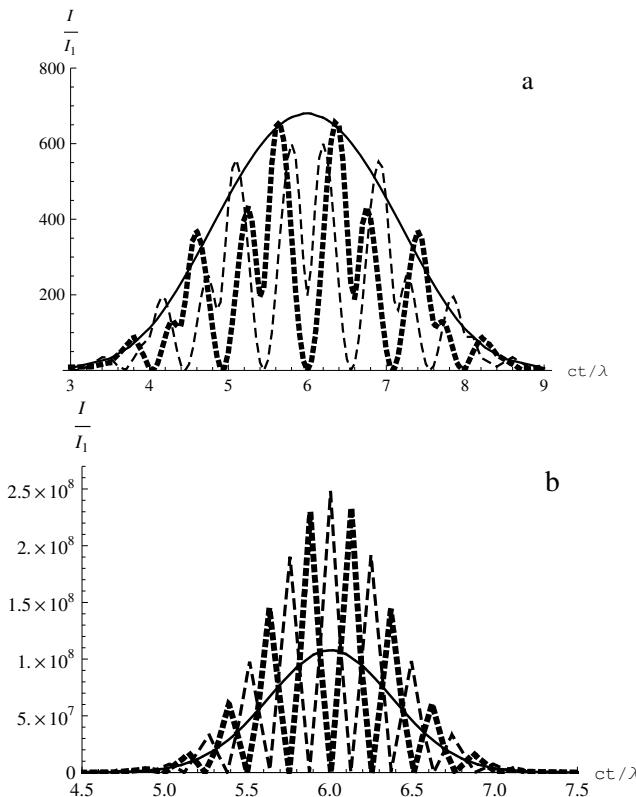
**Рис. 6.** Временной ход мощности излучения электрона при движении: *a* — вдоль симметричных траекторий рис. 1; *b* — с начальной кинетической энергией  $p = 20$  вдоль траекторий рис. 2;  $\alpha = 0$  (сплошные кривые),  $\alpha = 1$  (штриховые кривые),  $\alpha = -1$  (пунктирные кривые)
