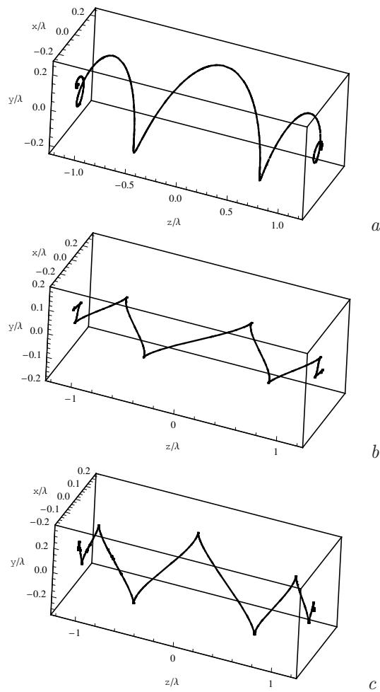
**Рис. 1.** Симметричные траектории электрона при  $\mu = 5$ ,  $\tau_c/\lambda = 1.5$ ,  $\alpha = 0$  (а), 1 (б), -1 (с)
