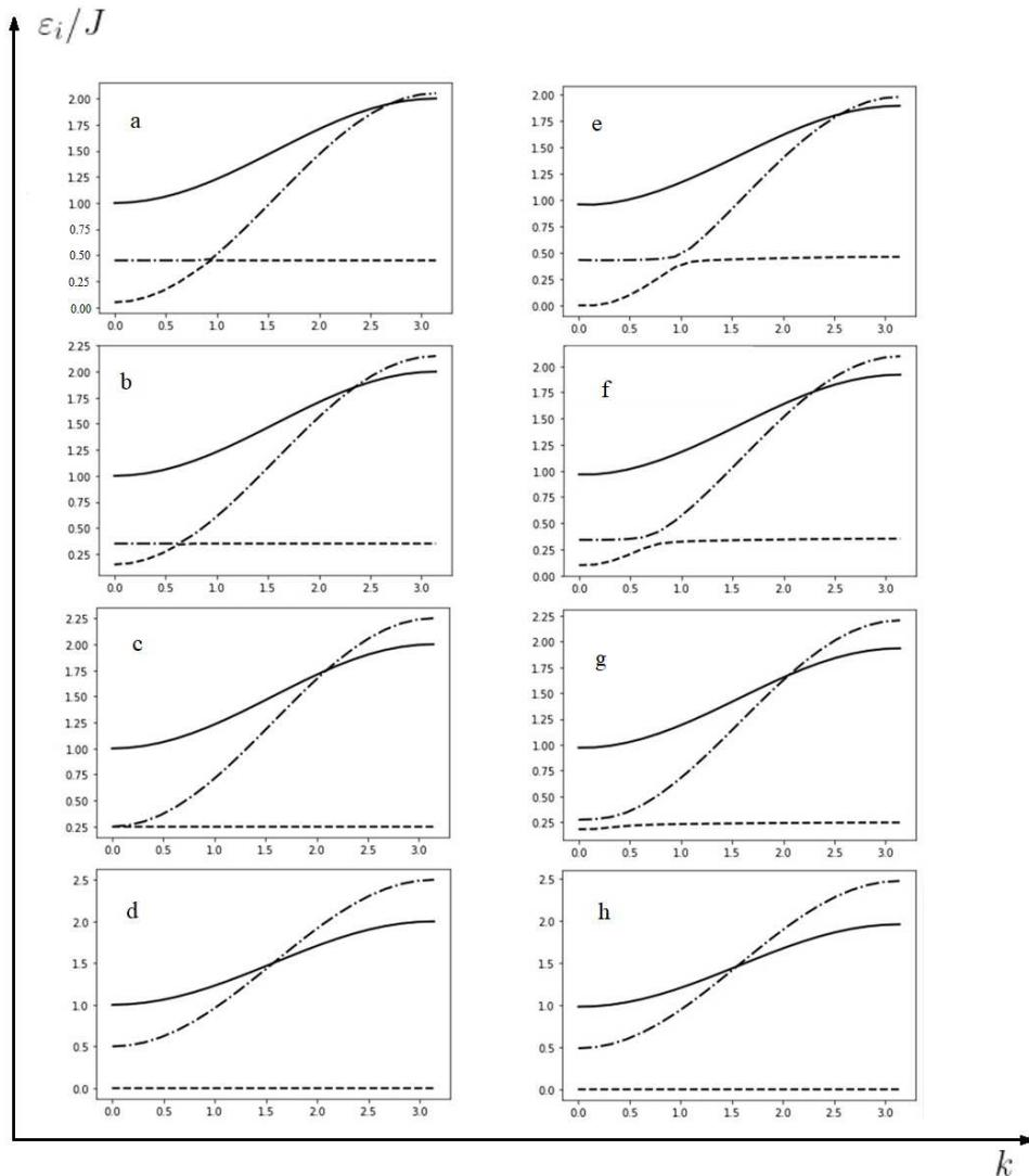
**Рис. 3.** Спектры элементарных возбуждений в FM-фазе при  $T/J = 0.003$  (*a–d*) и  $0.3$  (*e–h*) и значениях анизотропии  $D/J = 0.1$  (*a, e*),  $0.3$  (*b, f*),  $0.5$  (*c, g*),  $1.0$  (*d, h*). Сплошным линиям соответствует «продольная» ветвь возбуждений  $\varepsilon_1^{\parallel}/J$ , штриховыми линиями — «поперечная» ветвь  $\varepsilon_2^{\perp}/J$ , а штрихпунктирным — «поперечная» ветвь  $\varepsilon_3^{\perp}/J$ , обменные интегралы  $J = 1$ ,  $K = 0.5$
