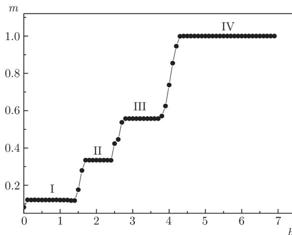
Рис. 9. Фазовая диаграмма зависимости параметра порядка от магнитного поля. Магнитное поле  $h$  приводится в единицах  $J_1$
