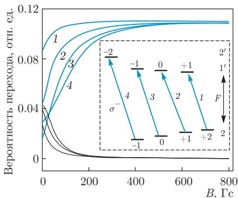
**Рис. 6.** Вероятности семи переходов  $F_g = 2 \rightarrow F_e = 1, 2$  в зависимости от  $B$  для  $\sigma^-$ -поляризации излучения. Переходы  $F_g = 2 \rightarrow F_e = 1$  обозначены 1–3. Номером 4 отмечен переход  $|2, -1\rangle \rightarrow |2, -2\rangle$ . Пять переходов с  $F_g = 1$  не приведены, так как их интенсивности с увеличением  $B$  быстро уменьшаются
