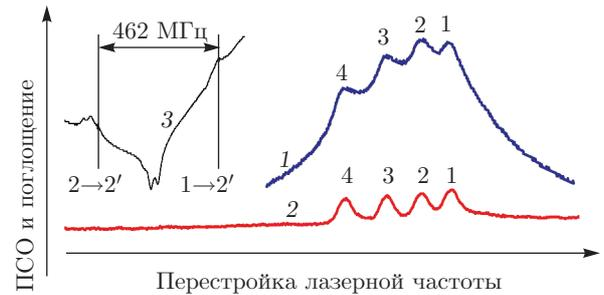
Рис. 4. Экспериментальный спектр поглощения калиевой наночейки толщиной  $L = 350$  нм при  $\sigma^+$ -поляризации излучения (кривая 1). Приложено продольное магнитное поле  $B = 500$  Гс. Четыре частично разрешенные атомные линии перекрываются широкими пьедесталами, что вызывает искажения реальных амплитуд. Приведены также спектр ПСО (кривая 2), на котором четыре атомные линии полностью разрешены, и реперный спектр, полученный методом насыщенного поглощения (кривая 3)
