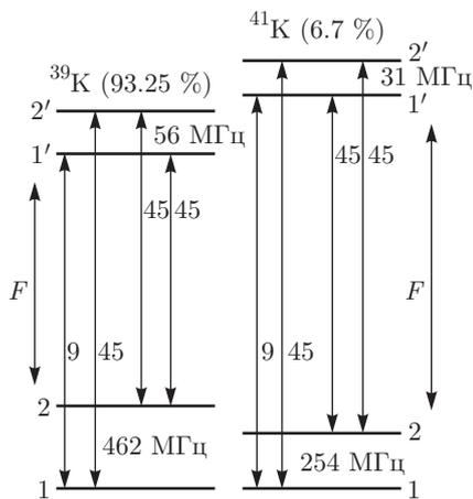
Рис. 1. Диаграммы энергетических уровней  $4^2S_{1/2}$ ,  $4^2P_{1/2}$  и атомных переходов для атомов  $^{39}\text{K}$  и  $^{41}\text{K}$ . Приведены относительные вероятности атомных переходов. Верхние уровни отмечены штрихами
