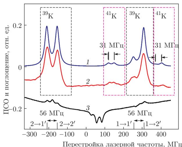
**Рис. 3.** Расчетный спектр поглощения атомов  $^{39,41}\text{K}$  с шириной линии перехода 25 МГц (кривая 1) и экспериментальный спектр, полученный методом ПСО (кривая 2). Мощность  $P_L = 0.1$  мВт,  $T_R \approx 150$  °С. Видны все 8 линий атомных переходов. Приведен также реперный спектр, полученный методом насыщенного поглощения (кривая 3). Кривые смещены по вертикали для удобства
