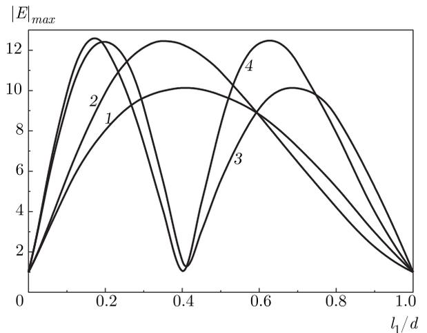
Рис. 4. Зависимость максимума модуля поля  $E_{max}$  от ширины области  $l_1$  с  $n_1 = 1.46$  для  $M = 50$ : кривые 1, 2 соответствуют первой запрещенной зоне, кривые 3, 4 — второй
