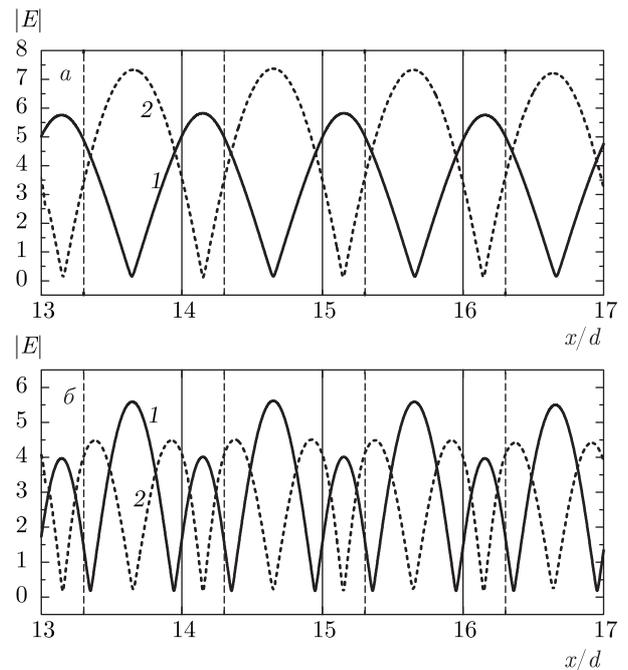
Рис. 7. Распределение модуля поля в структуре с  $n_1 = 1.46$ ,  $l_1 = 0.3$ ,  $M = 30$ . Сплошные линии — для первого максимума пропускания слева, пунктир — первый справа от первой (а) и второй (б) запрещенных зон
