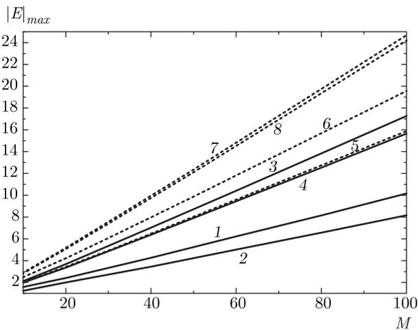
Рис. 6. Зависимость максимального значения электрического поля от количества периодов  $M$  для первых максимумов пропускания вблизи краев первой (1, 5 — слева, 2, 6 — справа) и второй (3, 7 — слева, 4, 8 — справа) запрещенных зон;  $n_1 = 1.46$ ,  $l_1 = 0.8d$  (сплошные 1–4) и  $l_1 = 0.2d$  (пунктир 5–8)
