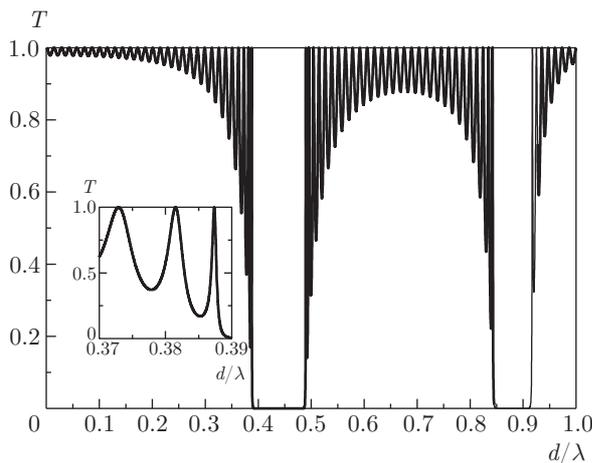
Рис. 1. Зависимость пропускания  $T$  от периода  $d$  для  $n_1 = 1.46$ ,  $M = 30$ ,  $l_1/d = 0.3$
