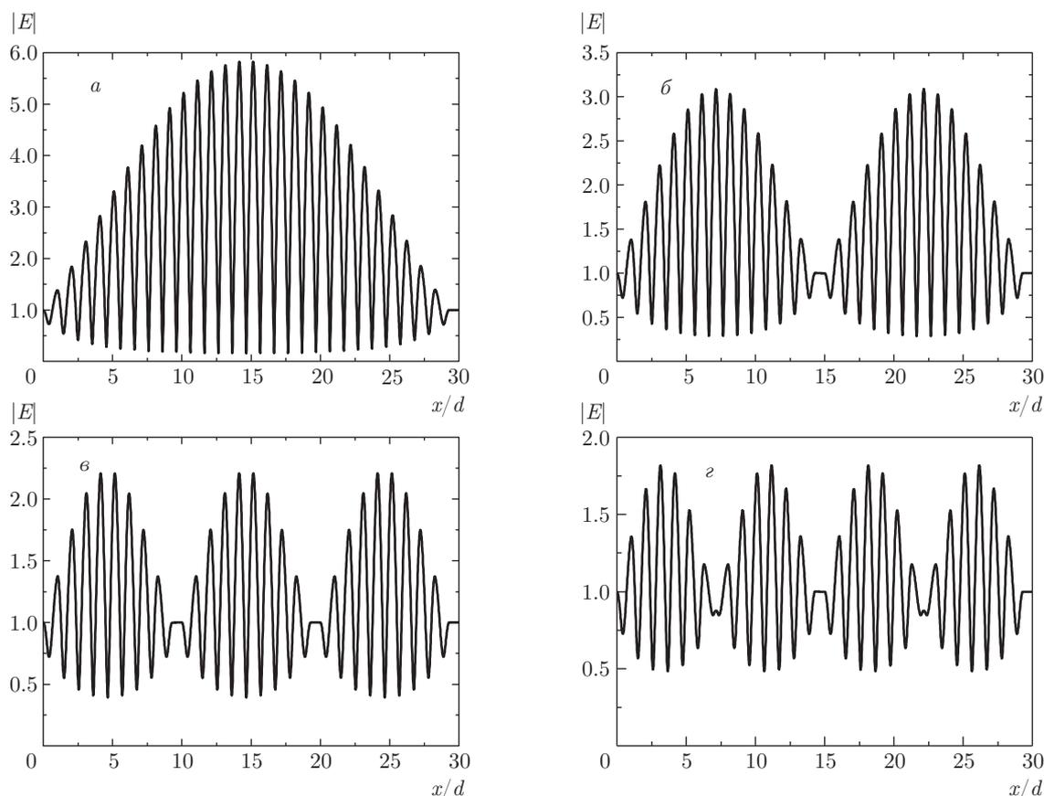
Рис. 2. Распределение модуля поля при  $M = 30, l_1 = 0.3d$  для первых четырех максимумов пропускания слева от первой запрещенной зоны ( $a - 1, б - 2, в - 3, г - 4$ ); значения  $d/\lambda$  равны соответственно 0.387, 0.382, 0.373, 0.363
