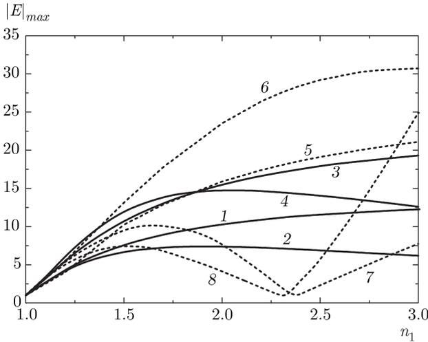
**Рис. 8.** Зависимость максимального значения поля от показателя преломления  $n_1$  для  $M = 50$ ,  $l_1 = 0.7d$  (кривые 1–4) и  $l_1 = 0.3d$  (кривые 5–8) для первых максимумов  $T$  около первой (1, 2, 5, 6) и второй (3, 4, 7, 8) запрещенных зон
