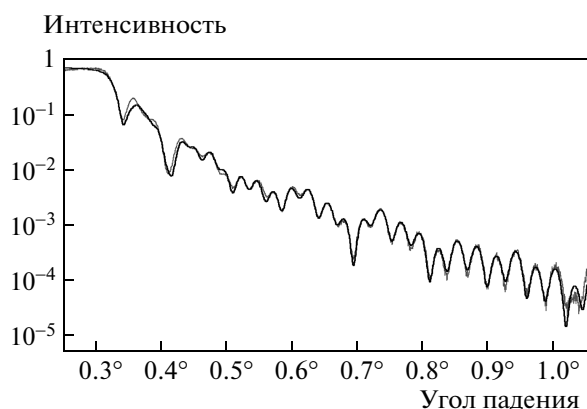
Рис. 2. Рефлектометрическая кривая для гетероструктуры с двумя КЯ (серая кривая) и ее моделирование для структуры с толщиной слоев 58.5 (ZnMgSSe) — 1.5 (переходный слой) — 10.5 (ZnCdSe) — 1.5 (переходный слой) — 25 (ZnMgSSe) — 10.5 (ZnCdSe) — 26.1 (ZnMgSSe) нм (черная кривая)
