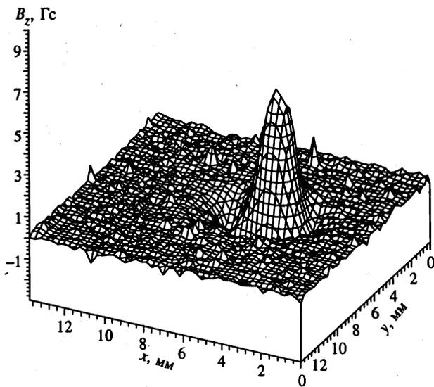
Рис. 4. Пространственное распределение остаточного магнитного поля  $B_z$  в пленке, измеренное сканирующим датчиком P1 после опускания микромагнита до высоты  $a < a_{cr}$  и последующего удаления его от пленки ( $T = 77$  K)
