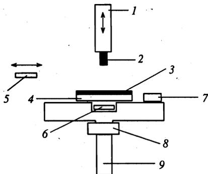
Рис. 1. Схема экспериментальной установки: 1 — штанга, 2 — микромагнит, 3 — пленка YBaCuO; 4 — подложка, 5 — сканирующий датчик Холла P1, 6 — неподвижный датчик Холла P2, 7 — термодатчик, 8 — нагреватель, 9 — хладагент
