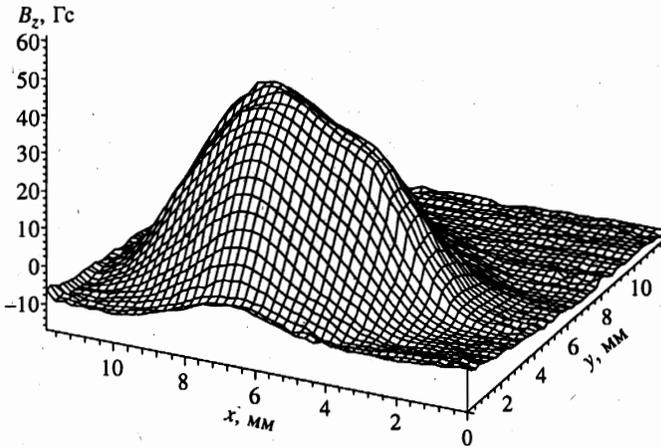
Рис. 2. Пространственное распределение остаточного магнитного поля  $B_z$  в пленке, измеренное сканирующим датчиком P1 после включения и выключения внешнего однородного магнитного поля ( $H = 500$  Гс,  $T = 77$  К)
