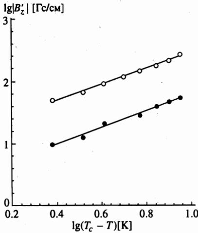
Рис. 7. Температурная зависимость  $B'_z = dB_z/da$  (● — эксперимент, ○ — теория)
