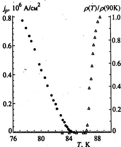
Рис. 3. Типичные температурные зависимости тока пиннинга  $j_p$  (•) и удельного сопротивления  $\rho$  ( $\Delta$ )
