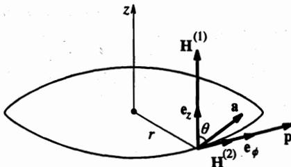
Поляризация частиц в аксиально-симметричном магнитном поле:  $r$  — радиус орбиты,  $e_\phi$  и  $e_z$  — орты цилиндрической системы координат,  $\mathbf{H}^{(1)}$  и  $\mathbf{H}^{(2)}$  — векторы напряженности однородного и поперечного неоднородного магнитных полей,  $\mathbf{p}$  — импульс частицы, вектор  $\mathbf{a}$  определяет направление ориентации спина,  $\theta$  — угол между вектором  $\mathbf{a}$  и осью  $z$
