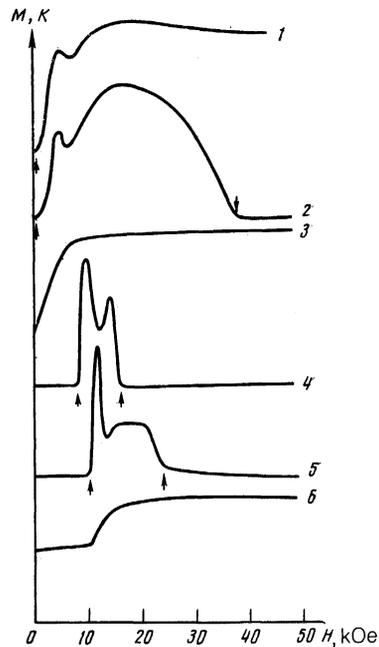
FIG. 2. Plots of  $K(H)$  and  $M(H)$  at  $\mathbf{H} \parallel \mathbf{b}$ .  $K(H)$ : 1— $T = 50$  K, attenuation 0 dB; 2—70 K, 11 dB; 4—136 K, 24 dB; 5—173 K, 37 dB,  $M(H)$ : 3— $T = 70$  K; 6—173 K. The arrows mark the fields  $H_2$  and  $H_1$ .
