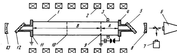
FIG. 1. Diagram of the apparatus: 1) chamber; 2) solenoid; 3) Rogowski loop; 4), 9), 10), and 11) electrodes; 5) and 12) Brewster windows; 6) and 7) radiation indicators; 8) and 13) resonator mirrors.
