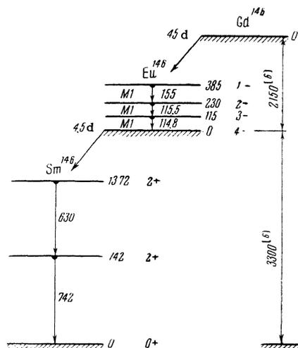
FIG. 3. Gd<sup>146</sup>  $\rightarrow$  Eu<sup>146</sup>  $\rightarrow$  Sm<sup>146</sup> decay scheme.
